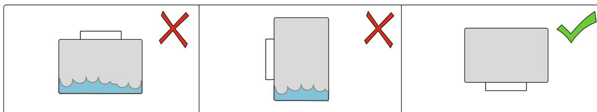
Блок устанавливать строго вниз разъемом во избежании в нем конденсата.
